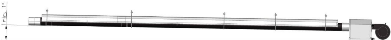
22. obrázok Minimálny sklon pri inštalácii
