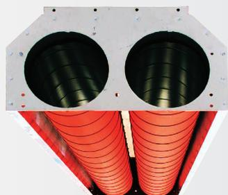
Moduly sálavého pásu jsou pevné a tvarově stabilní díky skořepinové konstrukci krytu sálavého potrubí. Mezi stěnami skořepiny je vrstva kvalitní izolace z minerálních vláken.
