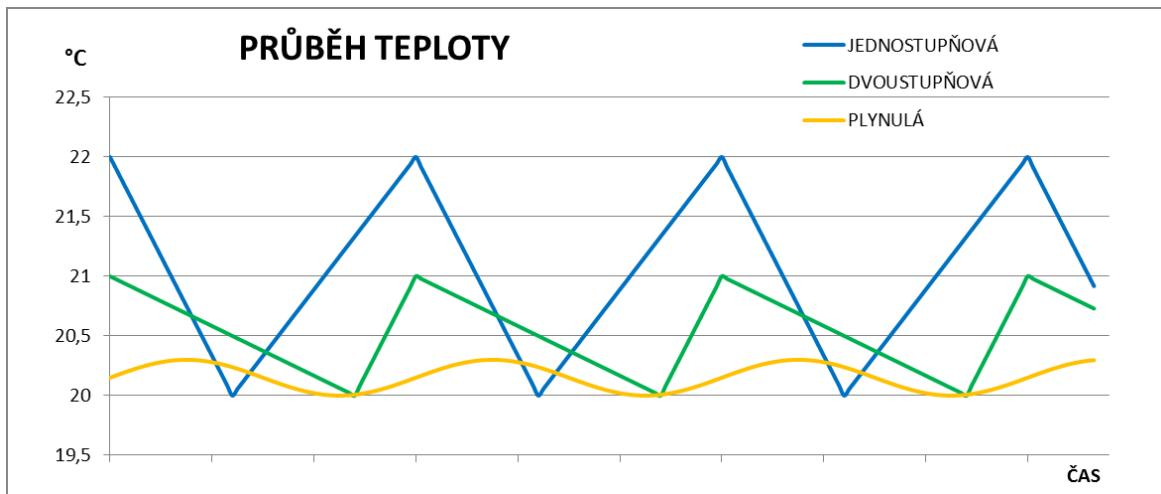
Při jednostupňové modulaci jsou rozdíly maximální a minimální teploty v čase největší, při plynulé modulaci nejmenší. Protože pro dosažení tepelné pohody je rozhodující minimální teplota ve vytápěném prostoru, při plynulé modulaci může být požadovaná teplota na regulaci nastavena na nižší hodnotu, z čehož plynou úspory paliva při vytápění.
