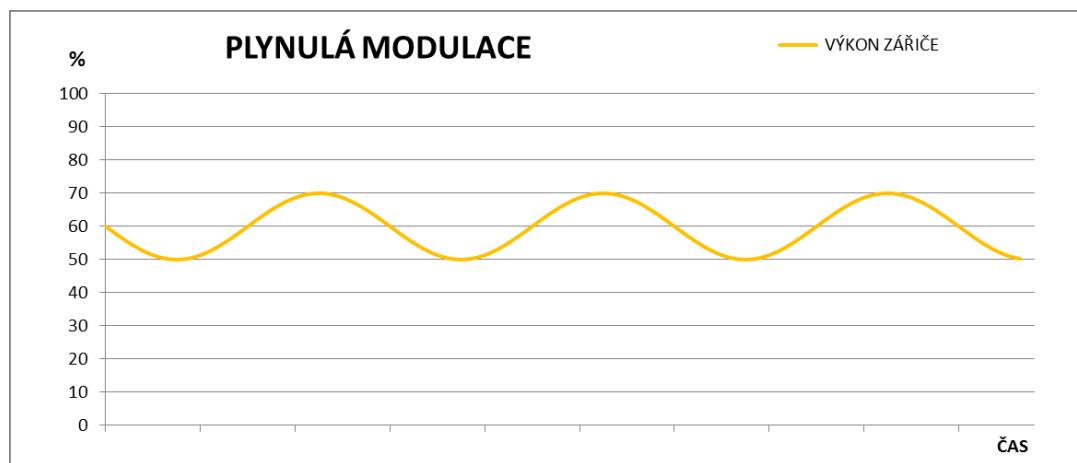
Průběh teploty ve vytápěném prostoru při nastavené konstantní požadované teplotě a při různých způsobech modulace výkonu zářiče znázorňuje následující graf:
